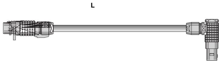
Bei Steckern mit Knickschutztülle aus Gummi, ist es die hintere Spannmutter. Die Stecker werden nicht zur Kabellänge hinzugerechnet.
