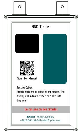
BNC-Kabel werden zur Verteilung von **HF-Signalen** verwendet, welche hohe Anforderungen an die Kabel stellen. Mit dem BNC-Tester können Sie **keine** Aussage über die Qualität der Signalübertragung treffen, dazu benötigen Sie ein teures Oszilloskop mit **Eye-Pattern-Messung** und v.a. die Fähigkeiten, diese Ergebnisse zu interpretieren.
